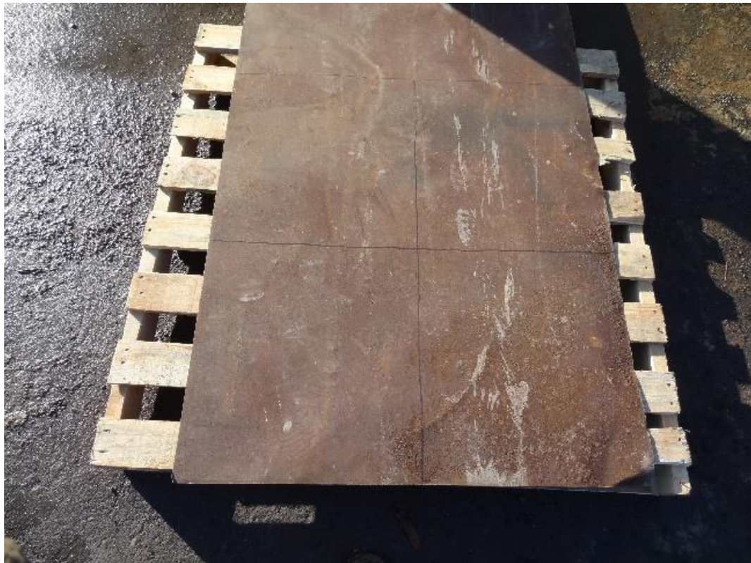
Figura 1 Presentación de la muestra tipo lámina con presencia de óxido (8:00 AM).
